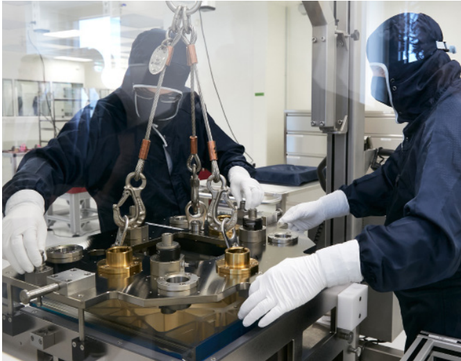
Reinraum der Niederlassung Berlin von ASML: Produktionsmitarbeiter stellen Komponenten und Baugruppen aus Glaskeramik und Keramik her.
